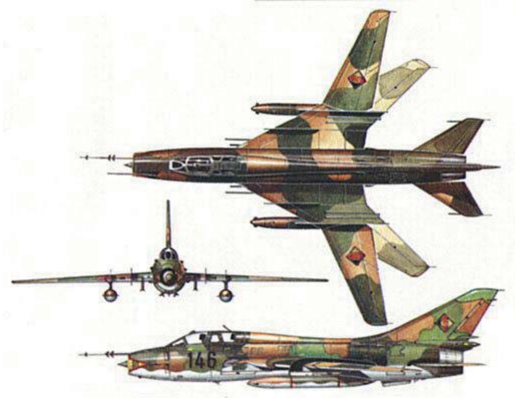
Рис. 3.2. Первый советский самолет с изменяемой стреловидностью крыла СУ-17
