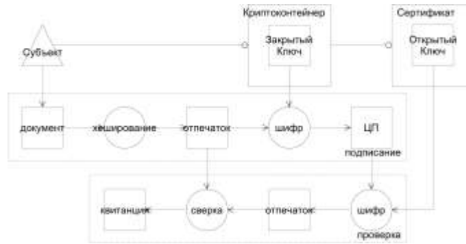
• Рис. 10. Схема работы цифровой подписи
